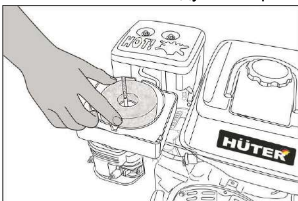
Рис. 36. Установка воздушного фильтра
