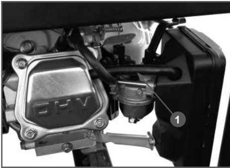
Рис. 14 Трубка системы вентиляции картера
