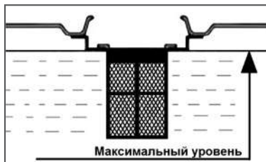
Рис. 10 Максимальный уровень топлива в топливном баке
