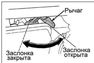
Рис. 11 Рычаг управления воздушной заслонкой
