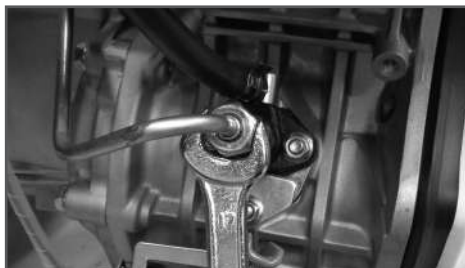
Рис. 12 Удаление воздуха из топливного насоса
